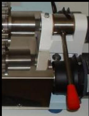
Neuer Reitstock mit Luftspulenwerkzeugaufnahme
