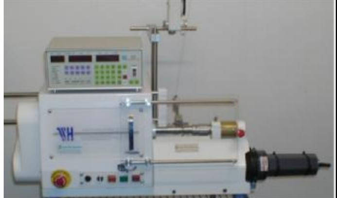
Durch die Feinsteuerung der Heißluftgebläsetemperatur der Luftstromgeschwindigkeit und der exakten Positionierung der Düse wird der Draht sowie das Werkzeug gerade soweit erwärmt, dass eine perfekte Drahtverbackung garantiert wird und die Spule trotzdem leicht vom Werkzeug abzunehmen ist.
