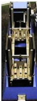
Wir möchten ihnen als Erstes mitteilen, welche Maschinen wir ihnen anbieten können. Der Bereich umfasst die EI-19 bis zur EI-162. Im Gegensatz zu viel teureren Versionen wird für jede Blechabmessung diese Schachtelmaschine speziell eingerichtet. Senden Sie uns Ihre **kundenspezifischen** Kernblechmuster, wir gewährleisten für Sie die richtigen Maschineneinstellungen.
