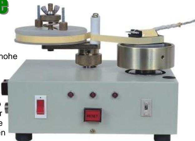
Die Maschine hat einen Fußschalter für eine optimale Produktivität. Die unterschiedlichen Spulengrößen werden in Backenfutter geklemmt, das Größen von **15 mm x 5 mm** bis **63 mm x 63 mm** aufnimmt. Magnete an den Backen erlauben dem Bediener ein einfaches Einsetzen in die Halterung...schnelle Handhabung (Max. Umdrehungen von 90 U/min).
