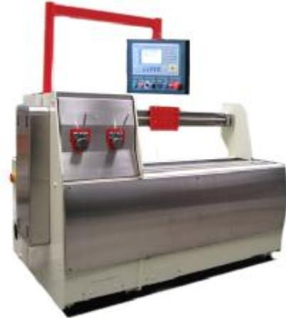
**4-Gang Getriebe**-bietet eine große Vielseitigkeit für Primärwicklungen mit hoher Wickelgeschwindigkeit, sowie ein hohes Drehmoment bei geringer Geschwindigkeit. Das ermöglicht der EZ900 das Wickeln von Dickdraht.
