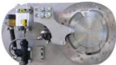
Dies ist eine pneumatische Version für Runddraht bis 5 mm>>>>
