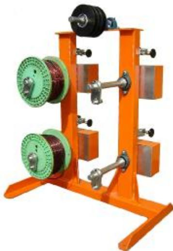
Um Beschädigungen der Isolierung beim Drahtabzug zu vermeiden, muss die Drahtspule selbst gebremst werden. Unsere 1, 2, 4 und 32 Drahtablaufeinheiten verwenden hydraulisch betriebene Scheibenbremsen zur genauen Kontrolle der Bremskraft.
