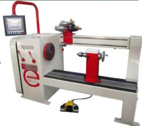
**4-Ganggetriebe der Spindel** —bietet eine große Vielseitigkeit für Primärwicklungen mit hoher Wickelgeschwindigkeit, sowie ein hohes Drehmoment bei geringer Geschwindigkeit.
