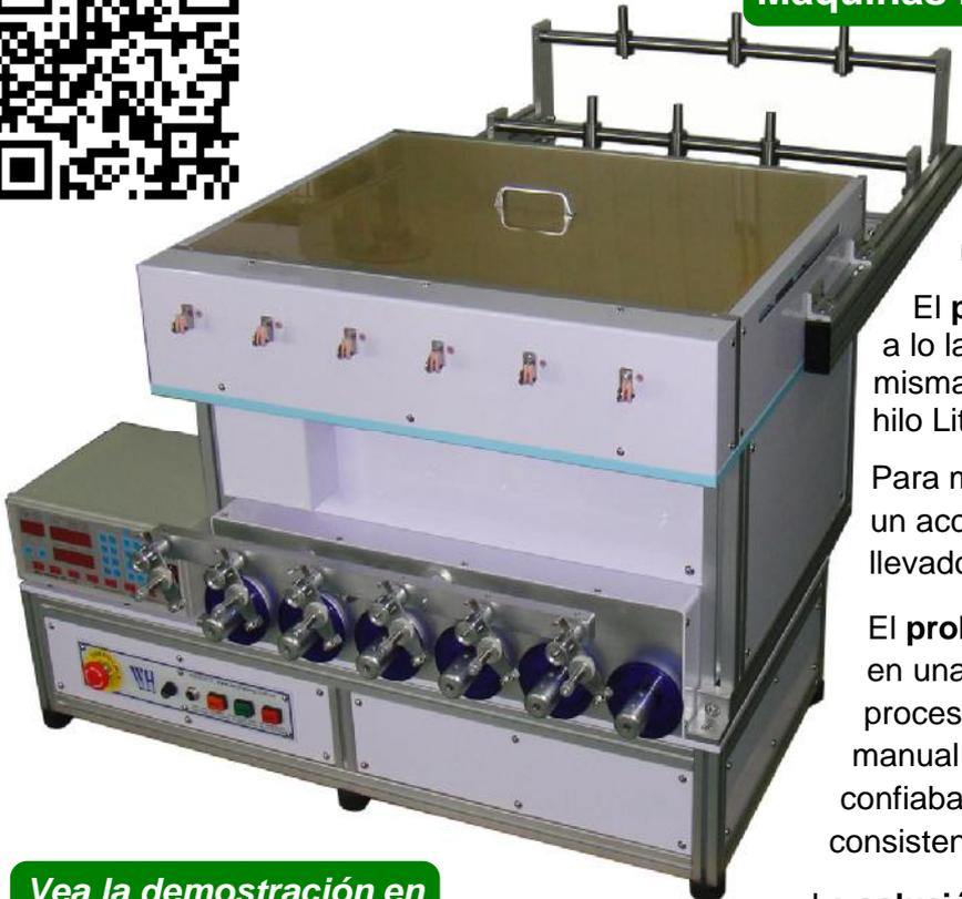
La palabra **devanado**, o doblar los hilos, se realiza para reforzar mecánicamente los hilos de una bobina frecuentemente para ayudar en el proceso de soldadura, o donde la vibración es un problema para cables mecánicamente débiles.
