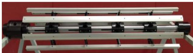
La **gama standard** de máquinas bobinadoras de ERASAN está disponible con bancos desde 30mm hasta 4 metros, con un par de **1400 Nm**.
