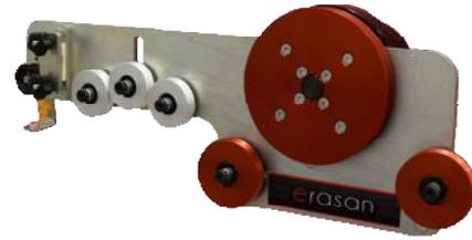
Unsere eigenen kundenspezifischen **Spreizdorne** (rechts) für Kupfer-, Aluminiumfolien oder Drähte, sowie Papier, gewährleisten einen schnellen und optimierten Arbeitsverlauf.
