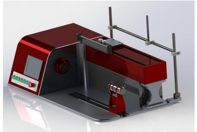
Die Maschine wurde für die Herstellung von Magnetspulen, Blindwiderständen, Wandler, und Transformatoren konstruiert und kann bis zu 200 unterschiedliche Wicklungen pro Spule auszuführen.
