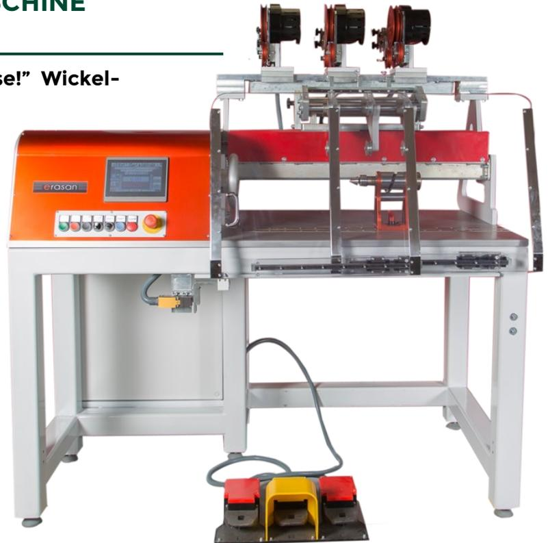
Die variablen Einstellungsmöglichkeiten der Wickelgeschwindigkeit von, ermöglichen es Erstwicklungen in sehr kurzer Produktionszeit zu realisieren.
