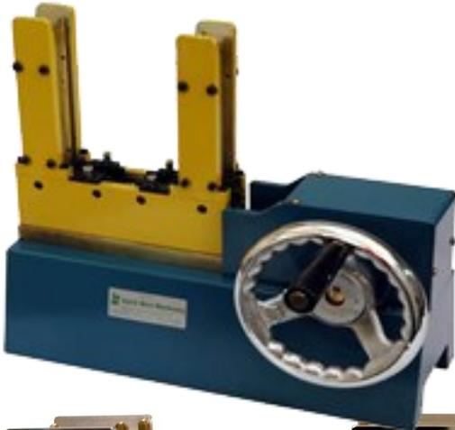
Diese Maschine schachtelt Standard EI Transformatorbleche in einem weiten Abmessungsbereich von EI-19 bis EI-162. Andere Abmessungen sind verfügbar.
