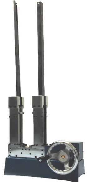
Transformatorblechstärke von 0.35mm - 0.5mm können bis zu 300 Stück/min. manuell oder automatisch geschachtelt werden.
