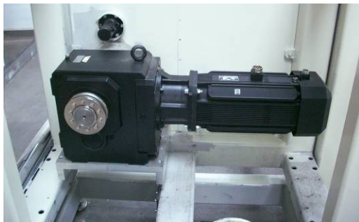
Robosztus kivitelű "Parker motor" integrált váltómű házzal.
