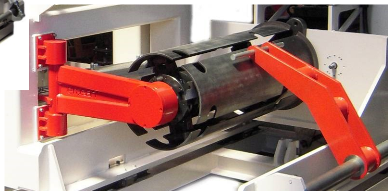
Az állítható méretű tekercstestek a megrendelő igénye szerint, a gyártandó terméknek megfelelően készülnek.
